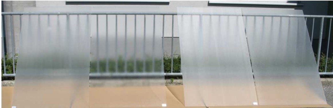
Abbildung 4: PV Gläser im Vergleich - von links nach rechts – Standard Glas ohne AR, Standard Glas mit AR, Extra clear mit AR, Extra clear ohne AR
